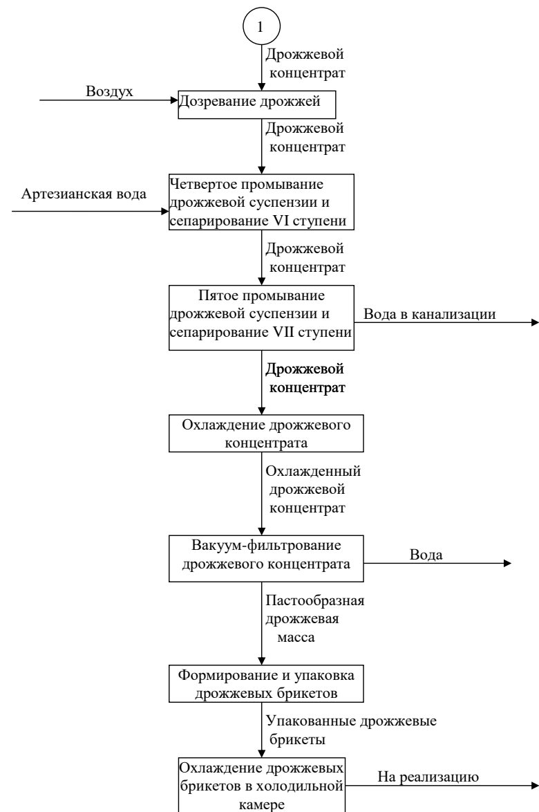
Рисунок 24 – Принципиальная технологическая схема производства хлебопекарных дрожжей на спиртовых заводах
